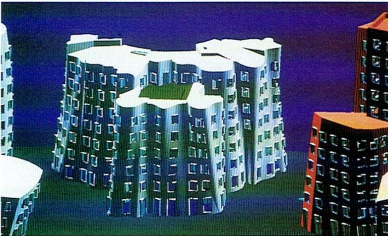
Bild 4: Eingescanntes, digitales Computermodell der Häuser A, B und C zur weiteren Bearbeitung
